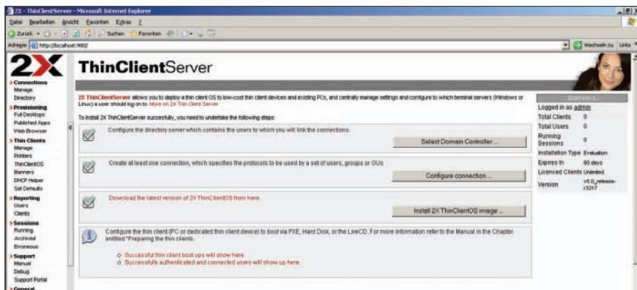
Bild 2: Die Einrichtung der Thin Clients findet beim ThinClientServer PXES von 2X über eine übersichtliche Web-Oberfläche statt
